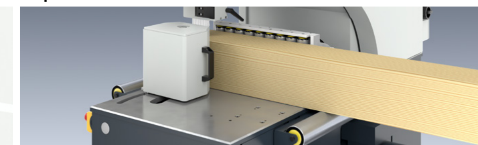
Rullo di appoggio: facilità l'introduzione di pezzi da lavorare particolarmente lunghi e pesanti
