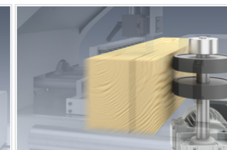
Avanzamento con regolazione a frequenza continua 5 - 40 m/min
